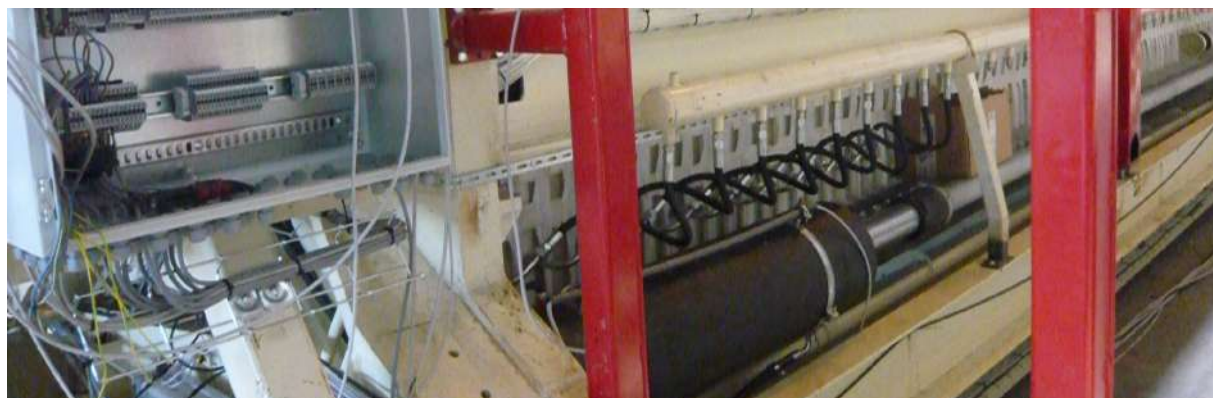
Hydraulic cylinder for sludge dewatering Vérin hydraulique pour la déshydratation des boues Hydraulikzylinder zur Schlammmentwässerung
